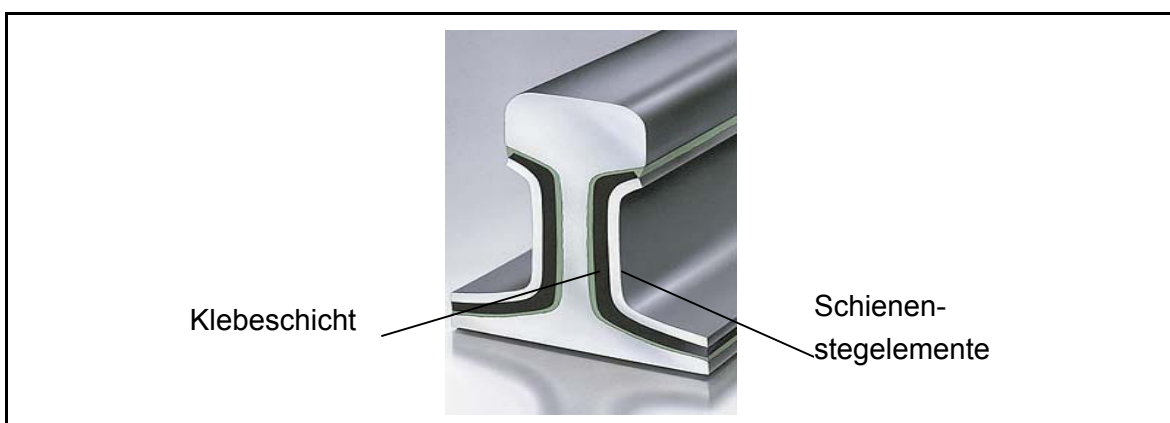
Abbildung 8-2: Schienenstegdämpfungssystem Vossloh (Bildquelle: [17])
