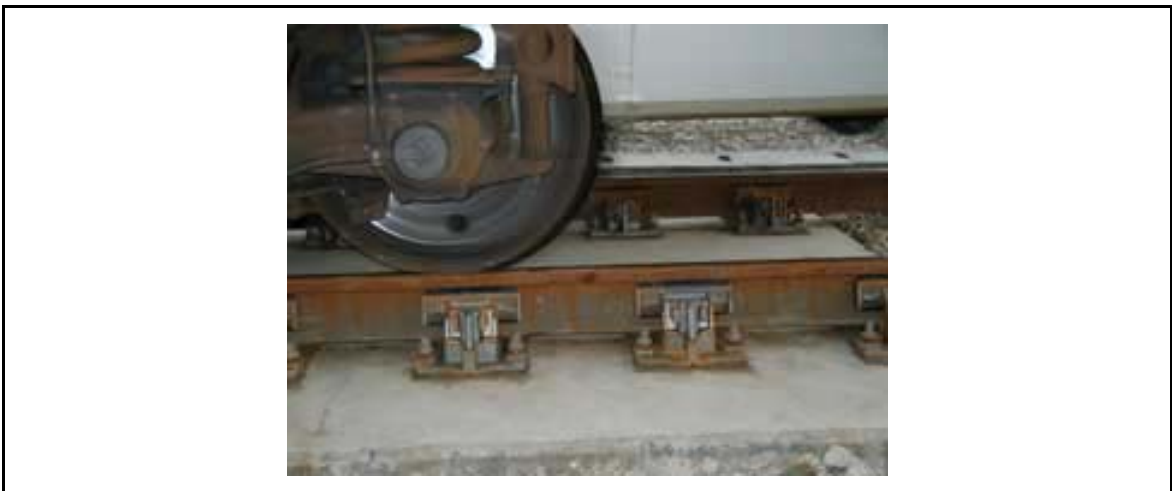
Abbildung 8-3: Schienendämpfungssystem Pandrol Vanguard (Bildquelle: [18])
