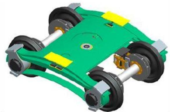
Abbildung 2: Eco-Bogie Konzept. Der Eco-Bogie Rahmen in Grün.
