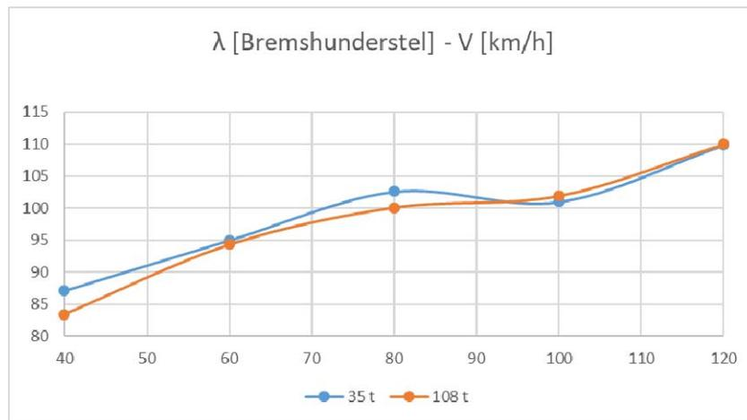
Abbildung 3 – Entwicklung des Bremshunderstels mit der Fahrgeschwindigkeit
