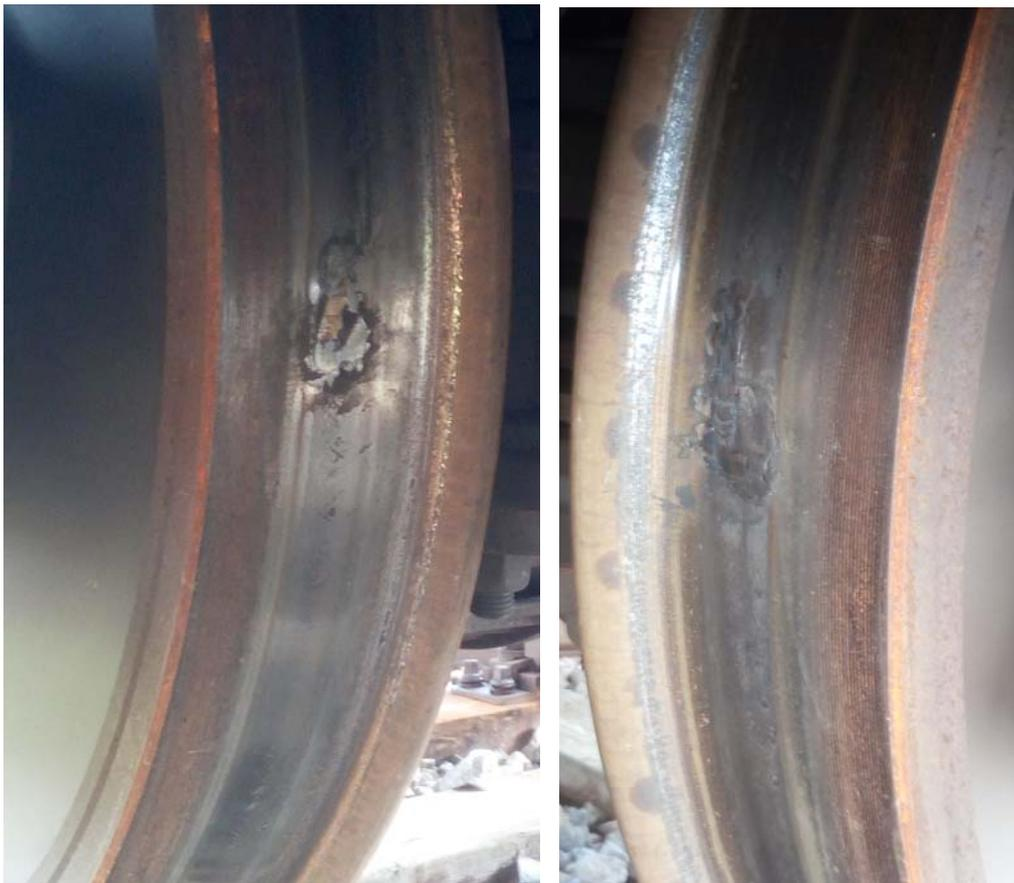
Abbildung 6 – Flachstellen bei linkem und rechtem Rad, Radsatz Nr. 05
