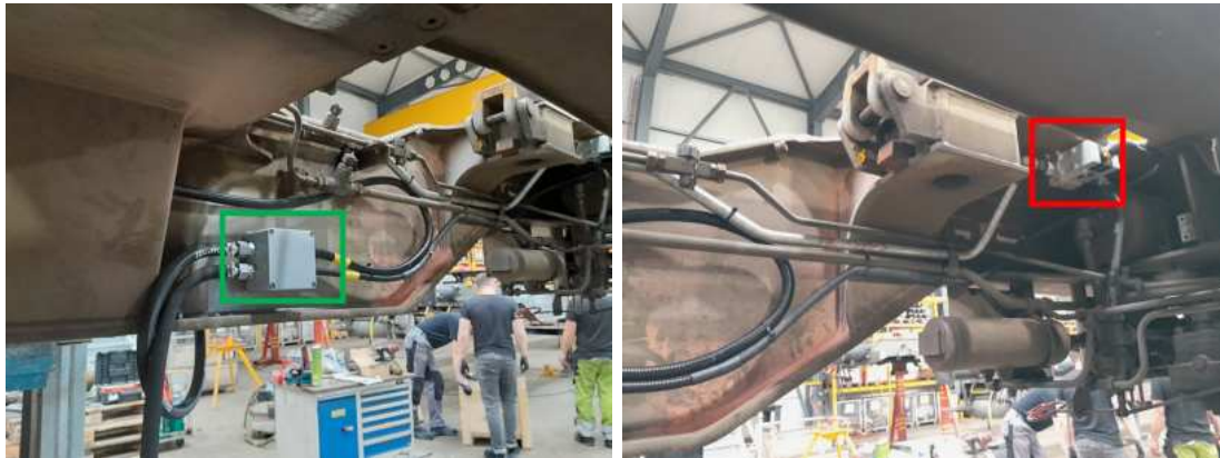
Abbildung 7.18: Anordnung des Klemmkastens und des GPS/GMS-Moduls am dritten Drehgestell nach Einbau [eigene Darstellung].
