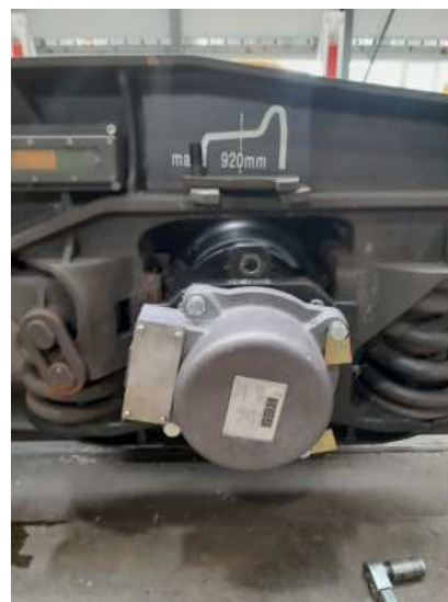
Abbildung 7.5: Dokumentation des Einbaus des Achslagergenerators [eigene Darstellung].
