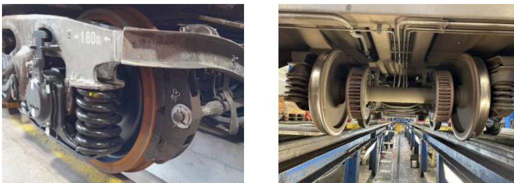
Abbildung 2.2: Klotzbremse (links) und Schieibenbremse (rechts) [eigene Darstellung].
