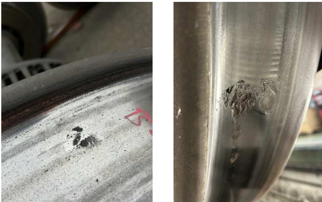
Abbildung 3.7: punktuelle Ausbröckelungen auf der Lauffläche [eigene Darstellung].
