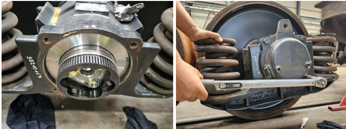
Abbildung 7.6: Dokumentation des Einbaus der Polräder [eigene Darstellung].
