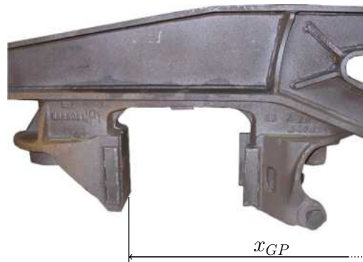
Abbildung 2.4: Darstellung Maße Abstand äußere Gleitplatten Drehgestellrahmen [veränderte Darstellung nach [31]].
