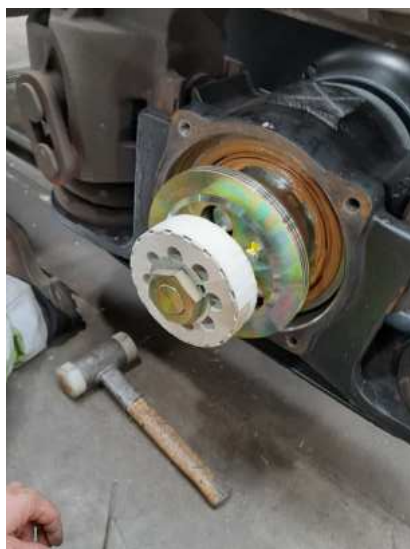
Abbildung 7.5: Dokumentation des Einbaus des Achslagergenerators [eigene Darstellung].
