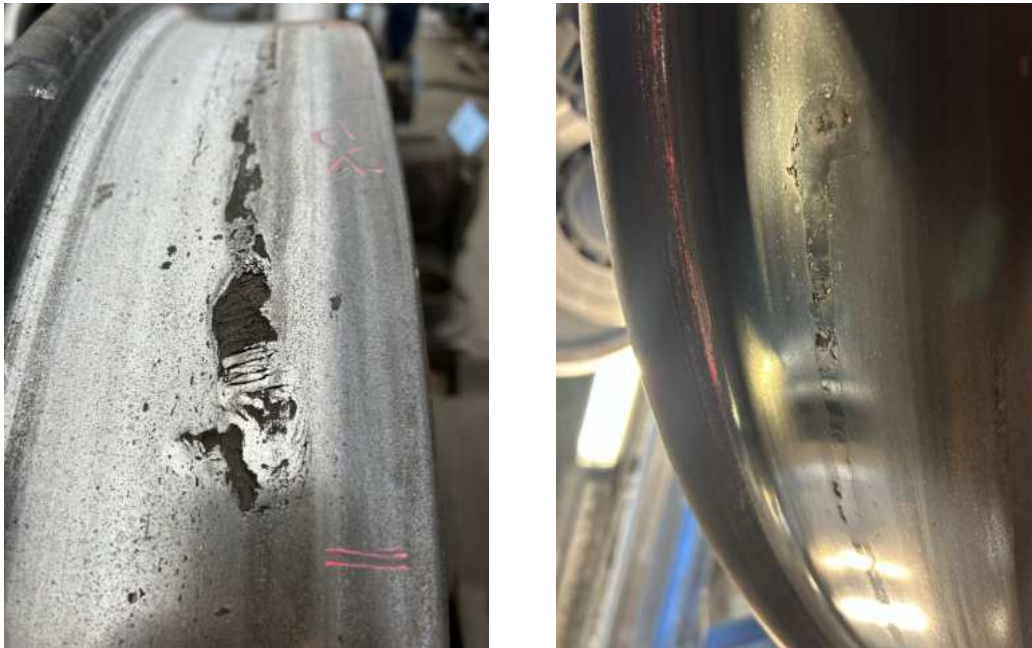
Abbildung 3.6: Ausbröckelungen längs der Lauffläche [eigene Darstellung].
