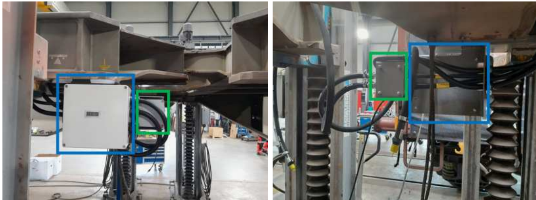
Abbildung 7.14: Anordnung des Klemmkastens und des GPS/GMS-Moduls am zweiten Drehgestell nach Einbau [eigene Darstellung].
